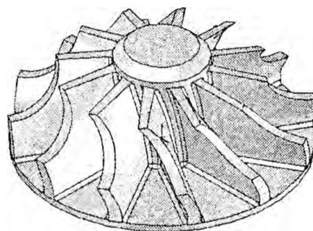
Рисунок 3 – Твердотельная модель радиального колеса
