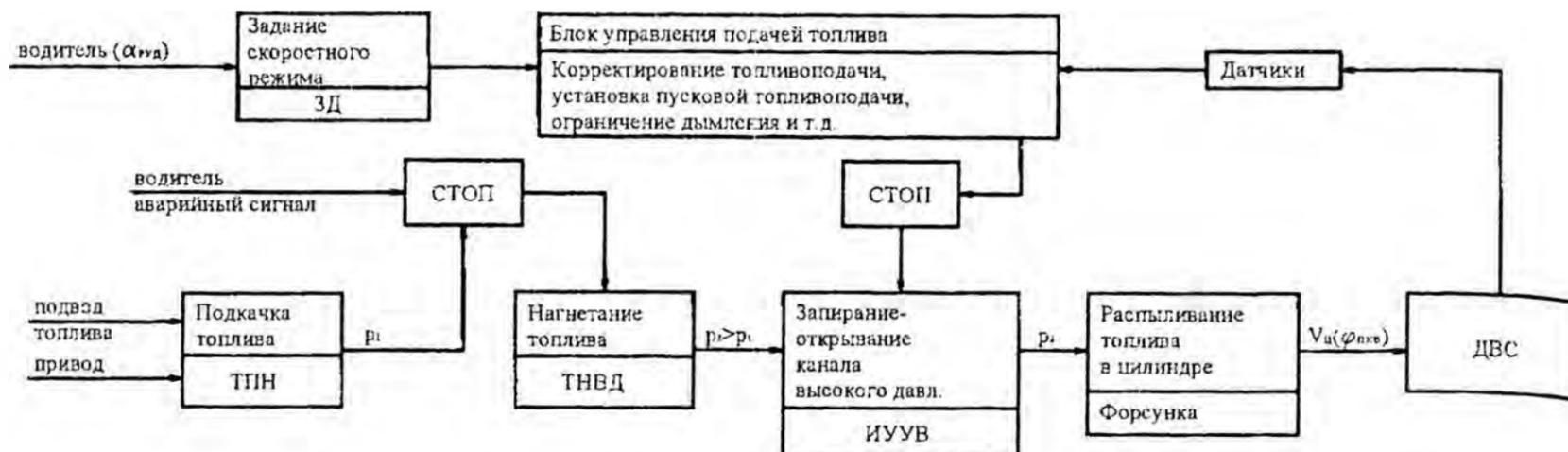
$p_1$ ,  $p_2$  – давление топлива;  $\alpha_{руд}$  – угловое положение рычага управления двигателем,  $p_k$  – давление наддува;  $V_{ц}(\varphi_{пкв})$  – закон подачи топлива в цилиндр; СТОП – аварийный выключатель
