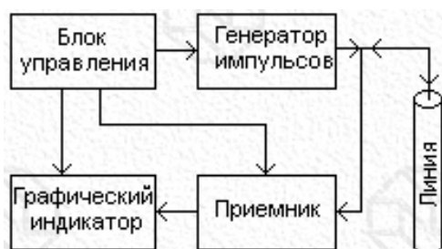
Рисунок 1 – Упрощенная структурная схема импульсного рефлектометра
