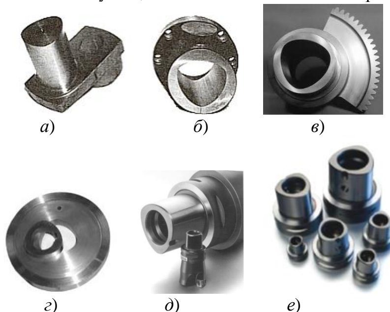
Рисунок 1– Примеры деталей машин ( а-в) и технологической оснастки (z-ж) с профильными моментопередающими поверхностями
