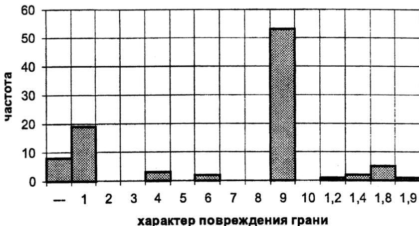
*Рис. 1. Гистограмма причин отказа твердосплавных режущих пластин KNVX-160410 из сплава марки МТ1 (производитель САНДВИК-МКТС).*
