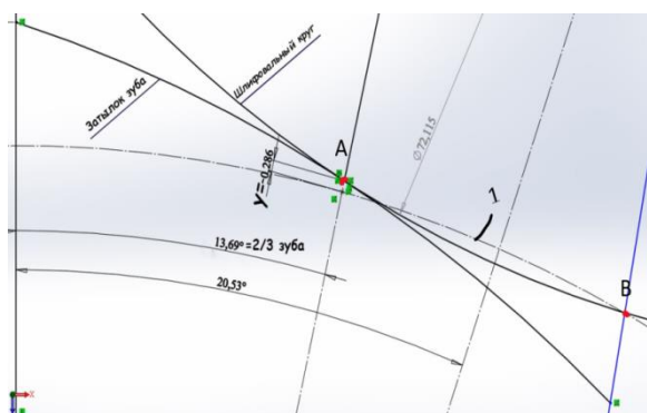
Рис. 12. Расчетная схема для определения влияния седлообразности на работу максимально сточенной фрезы: 1 – траектория движения точки В при фрезеровании; А – точка профиля максимально сточенного зуба; В – наиболее выступающая точка остаточной седлообразности; у – расстояние между точками А и В в процессе фрезерования
