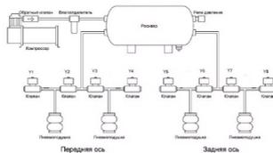
Рис. 1 – Схема пневматической подвески
