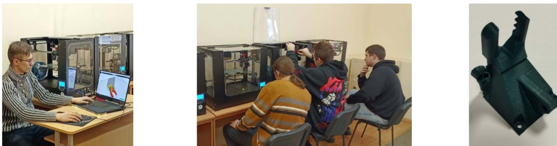
Рис. 1. Процесс подготовки и печати модели кронштейна в учебной лаборатории кафедры МиТЛП, Белорусский национальный технический университет
