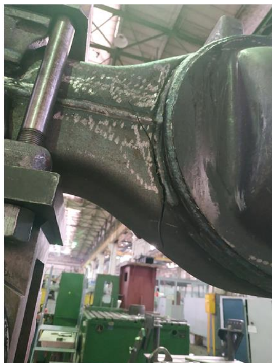
Рис. 6. Локализация разрушения картера ведущего моста при стендовых испытаниях
