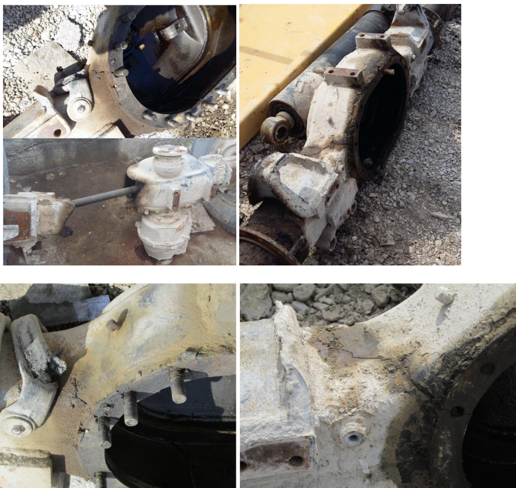
Рис. 4. Локализация эксплуатационных разрушений картеров ведущих мостов
