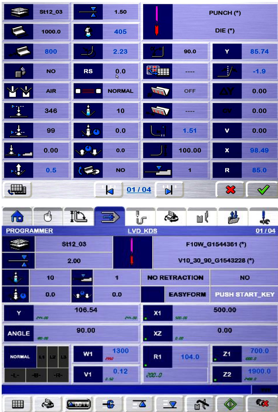
Рис. 13. Общий вид программы прессы при гибке лонжерона из различных металлов
