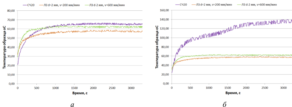
Рис. 8. Изменения температуры трения в зависимости от времени после лазерного упрочнения серого чугуна: а – при нагрузке 500 Н; б – при нагрузке 1000 Н
