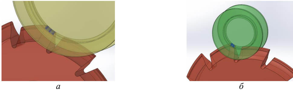
Рис. 7. 3D модель затылования фрезы модулем m = 2 мм на всю длину зуба (зарез смежного зуба): а – круг Ø42,7 (расчетный); б – круг Ø22,9 (смоделированный)
