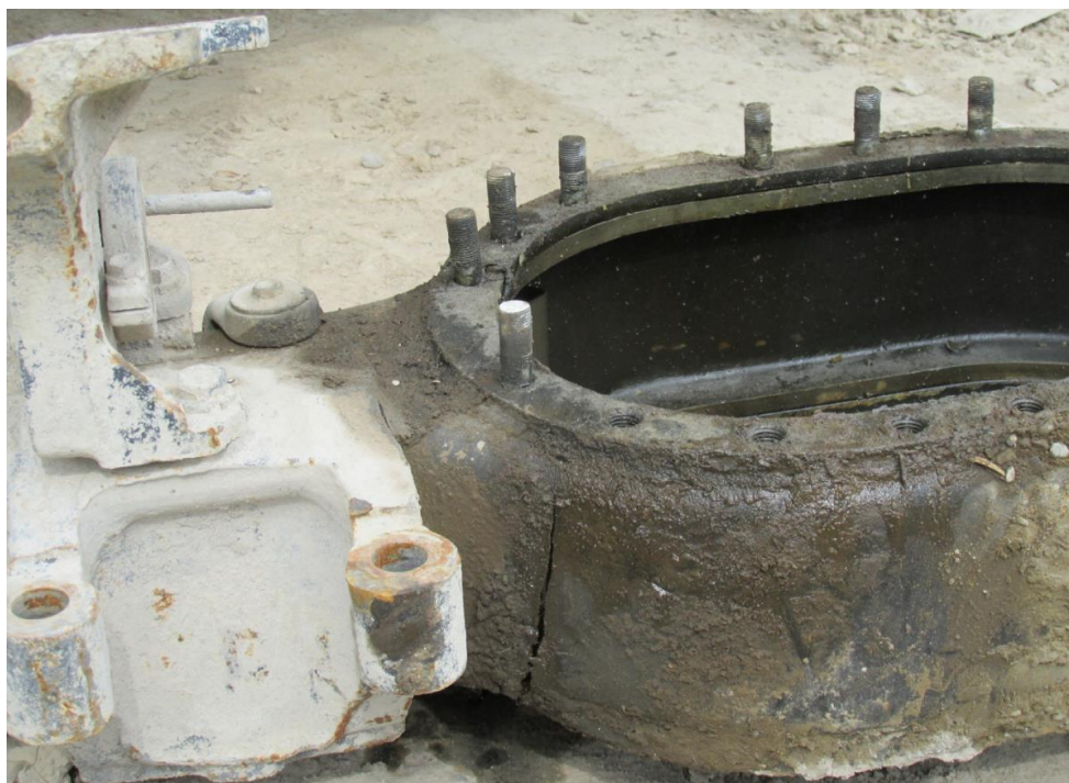
Рис. 5. Характерное эксплуатационное разрушение литого картера ведущего моста
