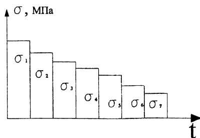
Рис. 3. Дискретный график нагружения микрообъема dv за 1 оборот подшипника в зависимости от D_{wi}
