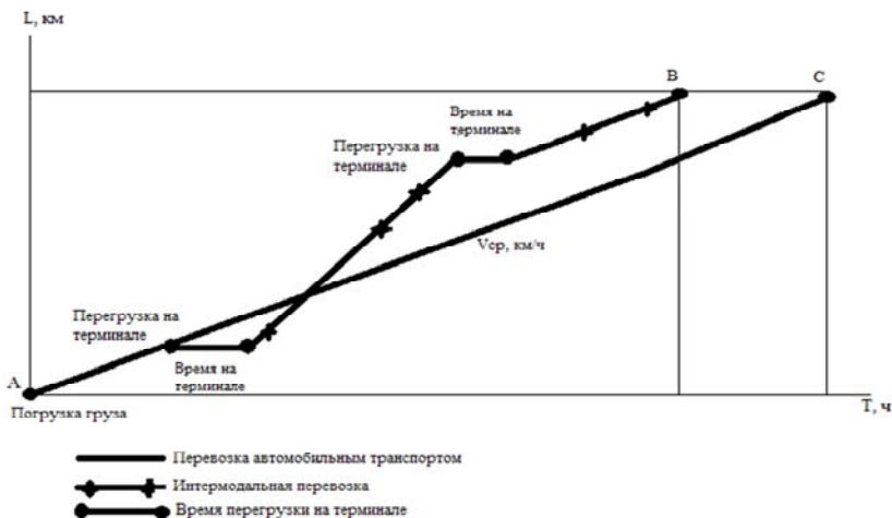
Рис. 4.6. Схема сравнения перевозки автомобильным и интермодальным транспортом
