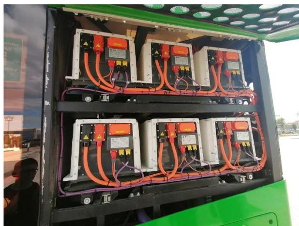
Рисунок 2 – Компоновка аккумуляторных модулей в электробусе
