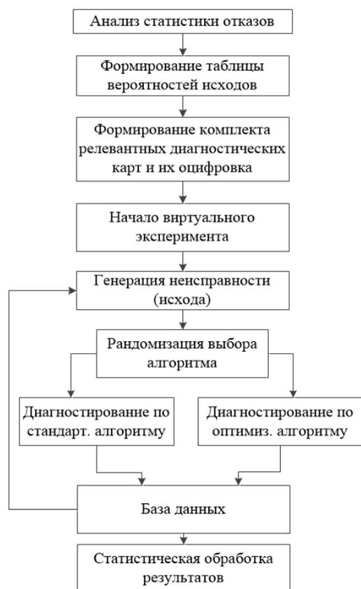
Рисунок 1 – Структурное преобразование алгоритма диагностирования
