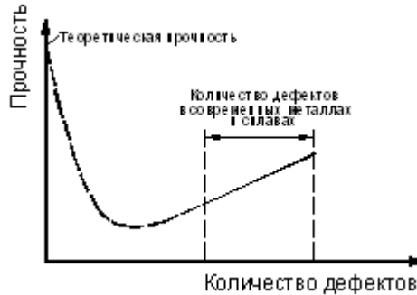
Рисунок 2. Изменение прочности металлов с ростом числа дислокаций
