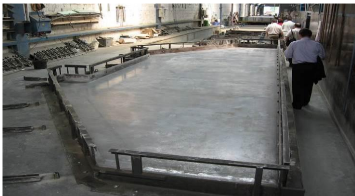
Рисунок 2. Производство стеновой панели нестандартной формы при помощи системы универсальный бортов и циркулирующих поддонов.
