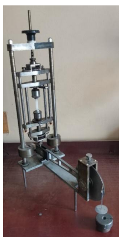
Рис. 2. Установка для испытания на ползучесть в условиях растяжения-сжатия
