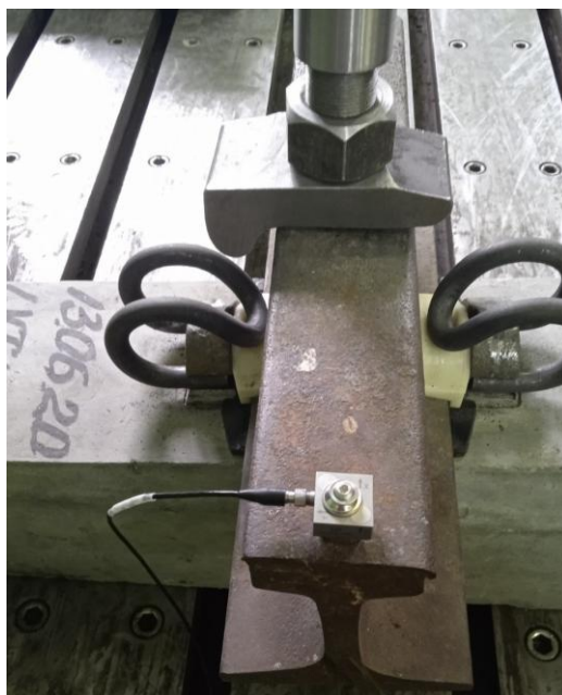
Рис. 4. Имитация взаимодействия колеса и рельса на испытательной установке
