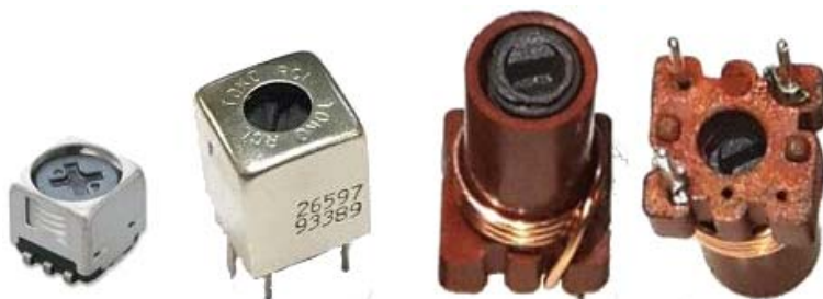
Рис. 22. Катушка с подстроечным сердечником
