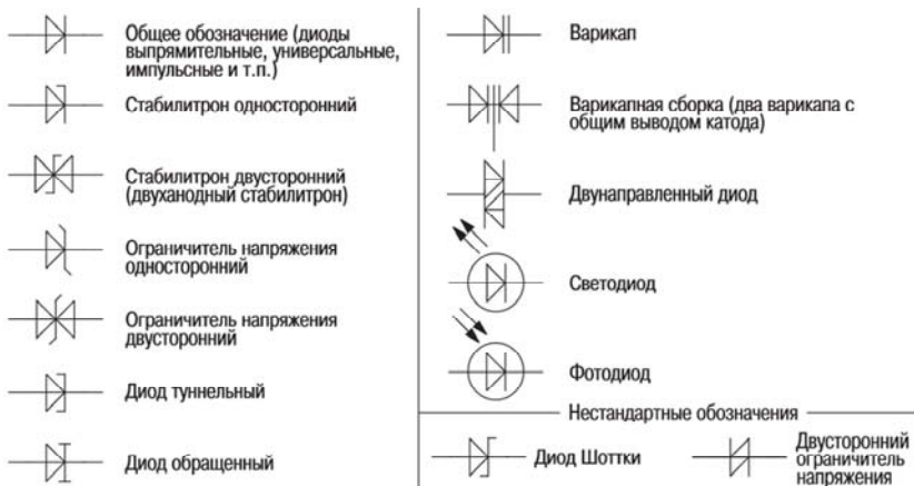
Рис. 24. Виды полупроводниковых диодов и их обозначение на электрических схемах
