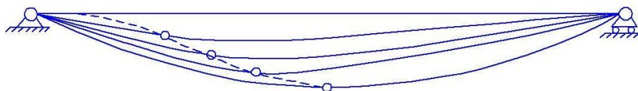
Рисунок 1 – Формы изгиба каната при различных положениях груза
