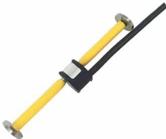
Рисунок 1 – закладной струнный тензометр
