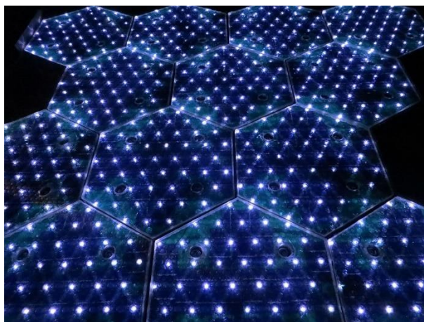
Рисунок 3 – Светодиодная подсветка на панелях Solar Roadways [5]
