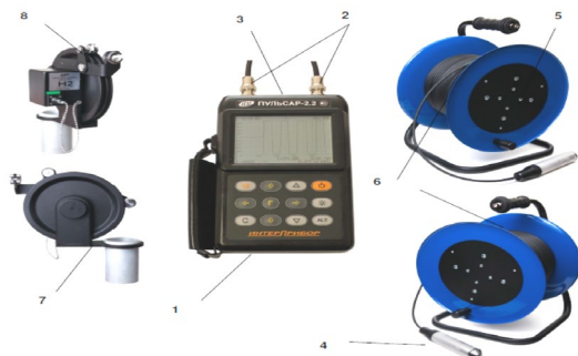
Рисунок 2. Состав измерительного комплекта «Пульсар-2.2 ДБС»: 1 – электронный блок; 2 – разъемы для подключения УЗ датчиков; 3 – разъем для подключения датчиков длины кабеля; 4 – УЗ датчик; 5 – смотчики кабеля; 6 – кабель для подключения УЗ датчиков (10 м); 7 – датчик положения (энкодер) Н1; 8 – датчик положения (энкодер) Н2
