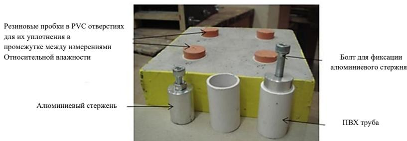
Рисунок 1. Бетонные блоки размером  $150 \times 150 \times 80$  мм вместе с вставками из ПВХ и различными приспособлениями для создания отверстий для контроля внутренних значений относительной влажности
