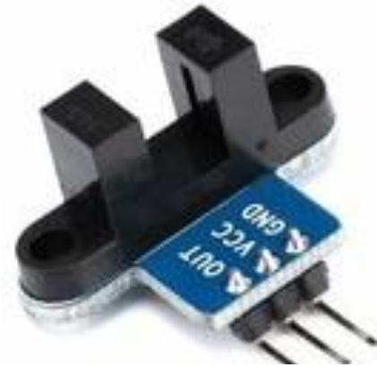
Рисунок 3. Оптическое устройство для определения угловых смещений и ускорений открытого типа
