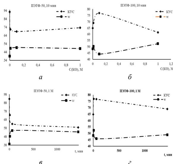
Рисунок 3 – Зависимость значений КУС и  $w$  (мДж/м<sup>2</sup>) образцов ПЭТФ-50 (а, в) и ПЭТФ-100 (б, з), модифицированных монослоем ПФДК от: а, б – концентрации красителя (время выдерживания 10 мин); в, з – времени выдерживания в 1 мг/мл растворе КО
