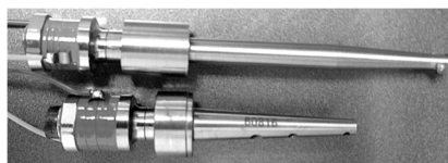
Рисунок 1 – Ультразвуковые преобразователи для микросварки проволочных выводов
