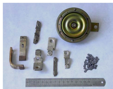
Рисунок 3 – Контакты из псевдосплавов W–Cu, W–Ag, выпускаемые Институтом порошковой металлургии имени академика О.В. Романа
