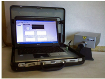
Рисунок 1 – Внешний вид спекл-анализатора микровибраций и смещений
