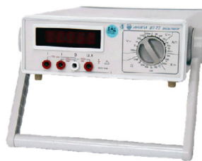
Рисунок 1 – Внешний вид вольтметра В7-77
