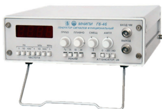
Рисунок 2 – Внешний вид генератор сигналов специальной формы Г6-46
