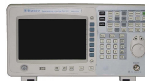
Рисунок 5 – Внешний вид анализатор спектра С4-101
