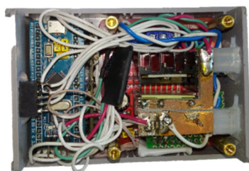
Рисунок 4 – Система управления приводами открывания окна и жалюзи
