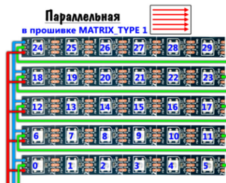
Рисунок 2 – параллельный тип подключения
