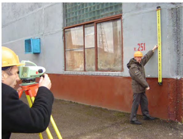
Рис. 1. Наведение зрительной трубы нивелира на кодовую рейку
