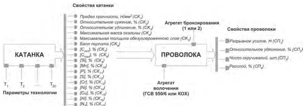
Рис. 1. Схема формирования свойств стальной бронзированной проволоки
