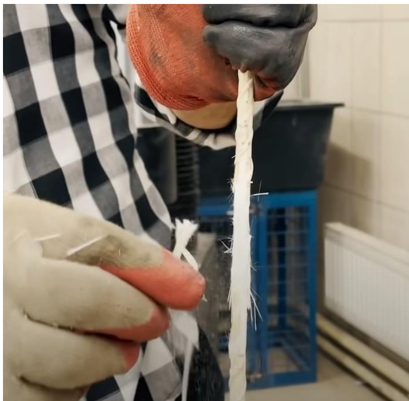
Рисунок 2 – Расслоение искусственно состаренного образца
