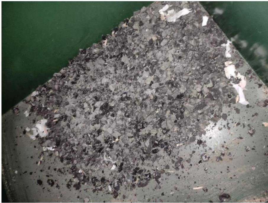
Рисунок 2 – Результаты измельчения кусков асфальтобетона на шредере
