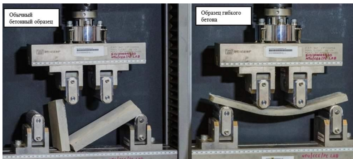
Рисунок 1 – Испытание гибкого бетона
