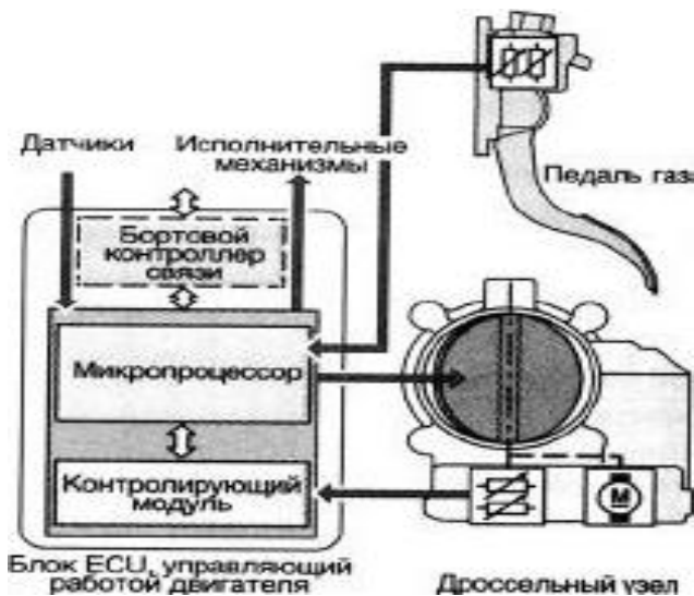
Рисунок 1 – Система ME-Motronic с электронным управлением дроссельной заслонкой
