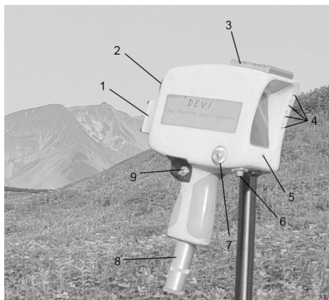
1 – видеокамера; 2 – объектив спектрометра; 3 – радиатор; 4 – кнопки выбора режимов работы; 5 – кнопка перезагрузки; 6 – разъем для подключения внешнего питания; 7 – энкодер; 8 – дополнительный отсек с батареей; 9 – кнопка включения
