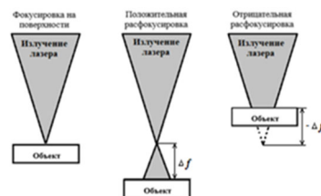
Рисунок 1 – Схематическое изображение различных схем фокусировки лазерного луча относительно поверхности объекта
