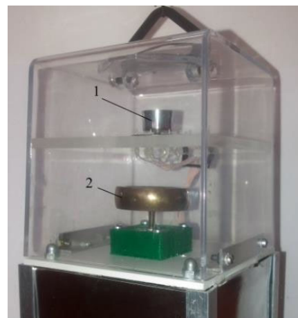
1 – волновой твердотельный гироскоп; 2 – двигатель маховик
