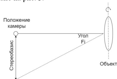
Рисунок 3 – Схема получение снимков с поворотом объекта
