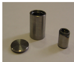
Рисунок 6 – Контейнеры из тяжелых сплавов ВНЖ-95 для хранения радиоактивных материалов
