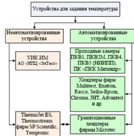
Рисунок 1 – Классификация устройств для задания температур при тестировании ЭКБ
