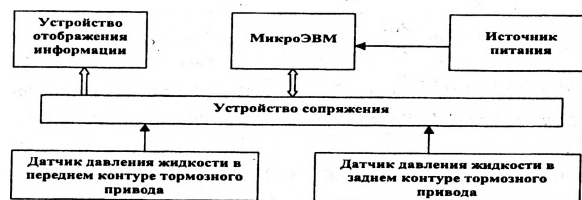
Рис. 1. Структурная схема системы бортового диагностирования датчиков давления жидкости в контурах тормозного привода
