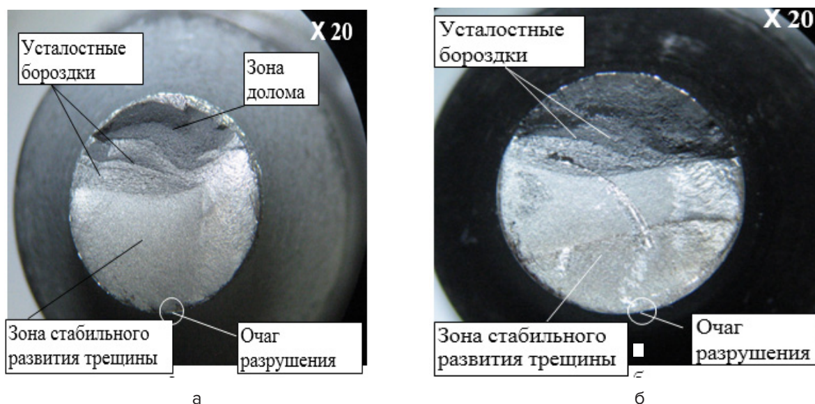
Рис. 3. Характер изломов образцов из стали 45 после усталостных испытаний: а — образец с цинковым диффузионным слоем; б — образец без защитного покрытия
