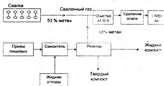
Рис. 4. Схема станции по использованию муниципальных и пищевых отходов Аммана
