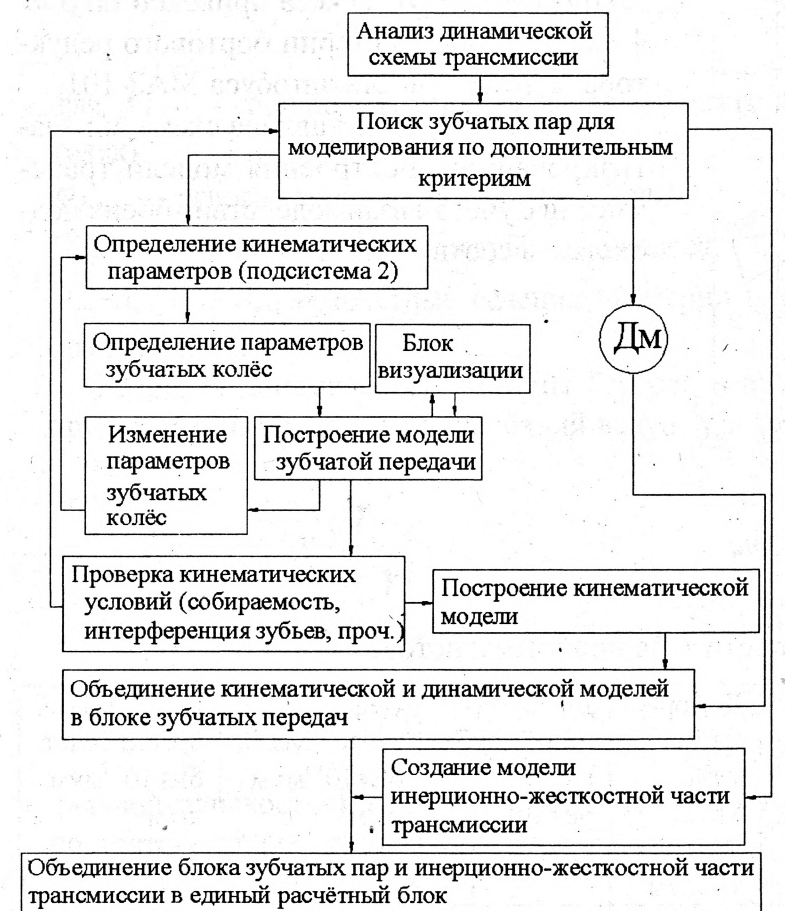
Рис. 5. Взаимосвязь кинематической и динамической моделей в едином расчетном блоке модели трансмиссии.
