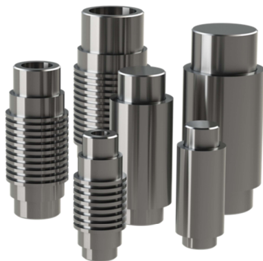
Рис. 4.2. Формы для изготовления образцов
