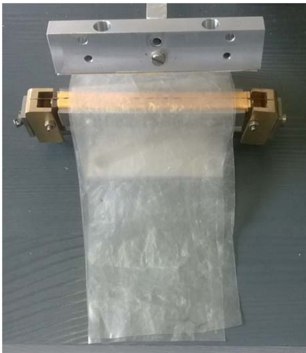
Рис. 14.23. Фотография свариваемых пленок, расположенных на рабочей поверхности сварочной головки
