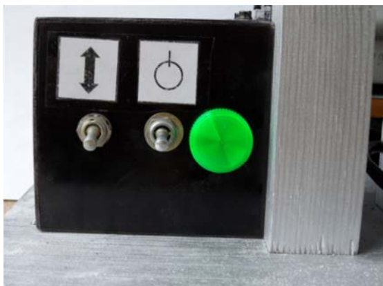
Рис. 13.17. Фотография пульта управления на устройстве измерения прочности
