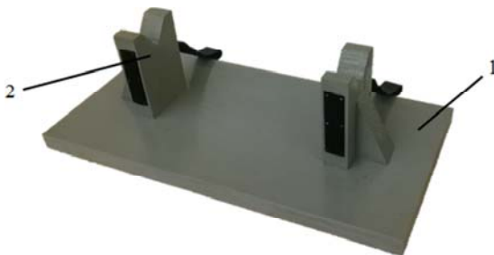
Рис. 10.17. Фотография приспособления для выполнения процедуры расширения макета стента:
