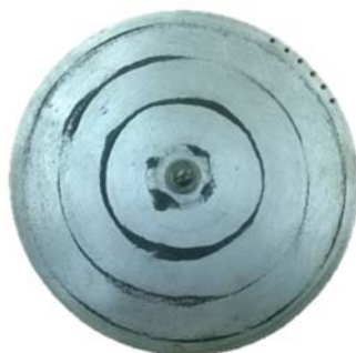
Рис. 1.13. Фотография фигуры Хладни, полученная на поверхности колеблющегося диска
