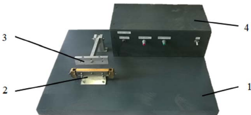
Рис. 14.14. Фотография общего вида: 1 – основание; 2, 3 – сварочная и прожимная головка; 4 – блок питания и управления
