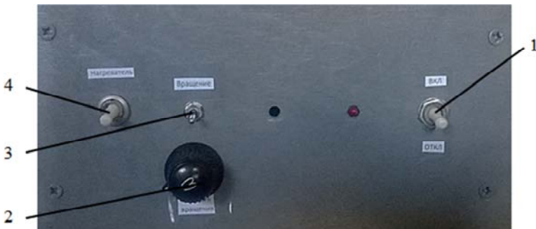
Рис. 8.16. Фотография панели управления устройства: 1 – тумблер подключения к сети питания; 2 – ручка потенциометра; 3 – тумблер питания электродвигателя; 4 – тумблер включения нагревательной лампы
