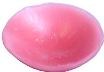
Рис. 8.18. Фотография макета контактной линзы из парафина, полученного методом центробежного формования
