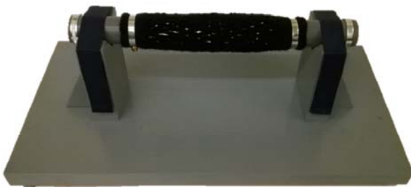
Рис. 10.19. Фотография макета стента установленного и закрепленного на призмах приспособления
