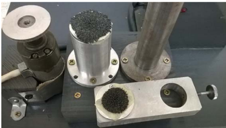
Рис. 12.19. Фотография магнитов с насыпанным на их поверхность магнитно-абразивным порошком
