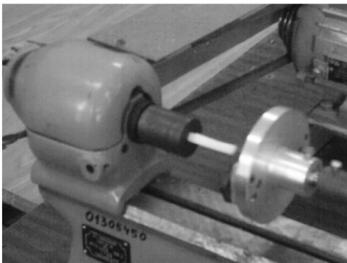
Рис. 14.19. Фотография установленного на лабораторной установке стержневого образца квадратного сечения
