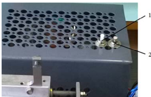
Рис. 11.21. Фотография панели управления устройства: 1 – тумблер питания генератора импульсов; 2 – тумблер питания электродвигателя
