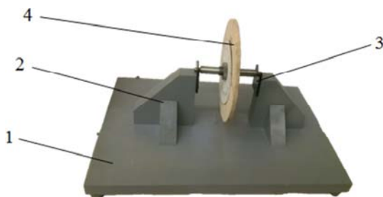
Рис. 4.15. Фотография общего вида приспособления для статической балансировки шлифовального круга:
