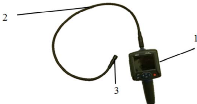
Рис. 5.18. Фотография общего вида эндоскопа: 1 – панель управления; 2 – зонд; 3 – камера
