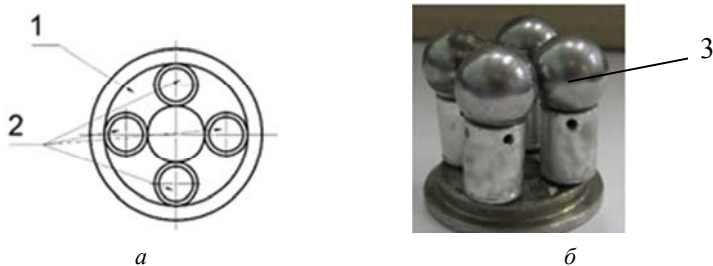
Рис. 13.14. Схема расположения соединений, получаемой на металлической поверхности образца имплантата (а) и фотография общего вида собранной конструкции (б):
