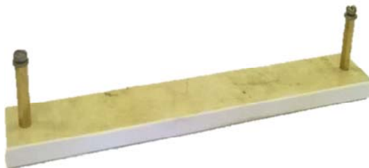
Рис. 10.22. Фотография приспособления для фиксирования концов нитиноловой проволоки в растянутом состоянии
