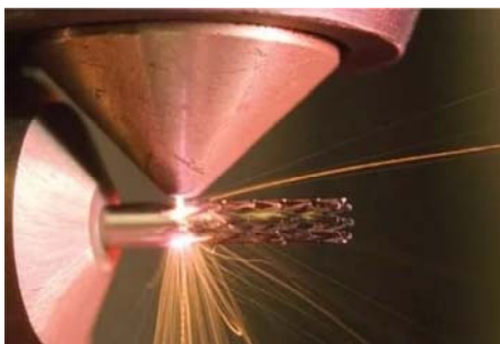
Рис. 10.12. Фотография зоны обработки при лазерной резке заготовки матричного стента
