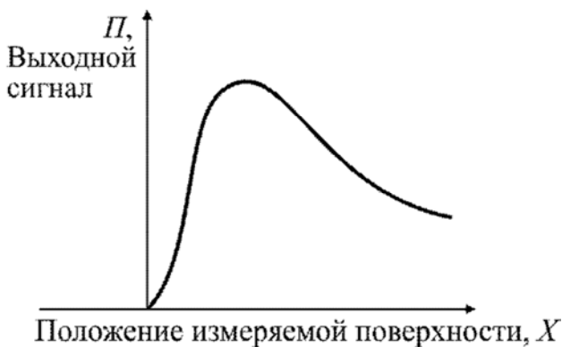
Рис. 1.8. Зависимость между измеряемым расстоянием и количеством отраженного света
