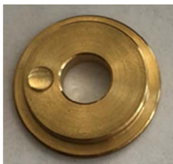
Рис. 13.18. Фотография нанесения капли жидкости на поверхность образца имплантата дозированной капли жидкости ( a ) и капля жидкости на поверхности образца имплантата ( б )
