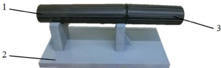
Рис. 5.19. Макет исследуемой полости: 1 – цилиндрический пластмассовый тубус; 2 – деревянное основание; 3 – съемная крышка
