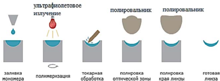
Рис. 8.10. Схематическое представление основных этапов изготовления мягких контактных линз обратным реверсивным процессом.
