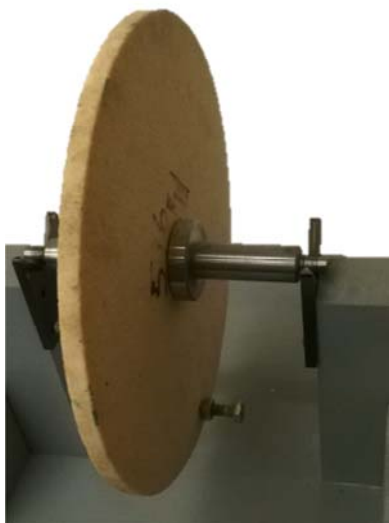
Рис. 4.19. Фотография приспособления для статической балансировки круга
