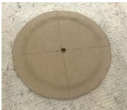
Рис. 12.22. Фотография состояния поверхности диска из картона, после ее магнитно-абразивной обработки
