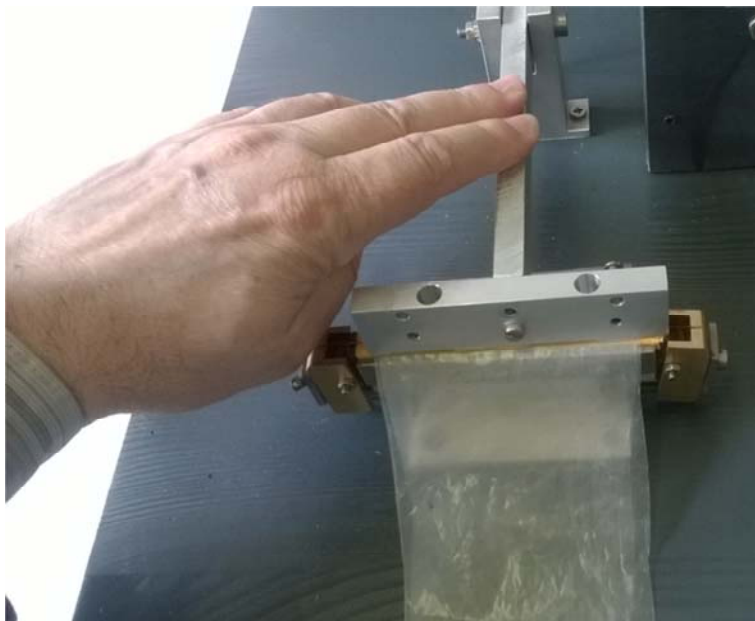
Рис. 14.24. Фотография рабочего положения прижимной головки
