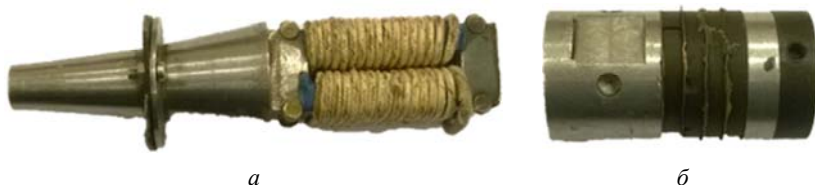
Рис. 1.12. Фотография общего вида: а – магнитострикционного преобразователя; б – пьезокерамического преобразователя
