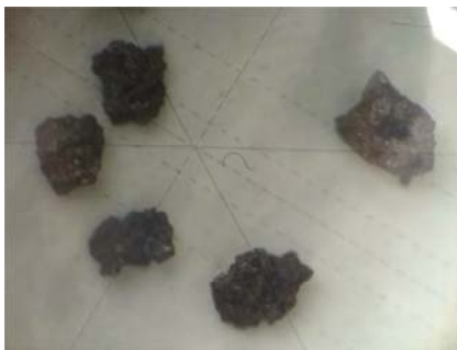
Рис. 12.18. Фотография зерен магнитно-абразивных порошка под микроскопом
