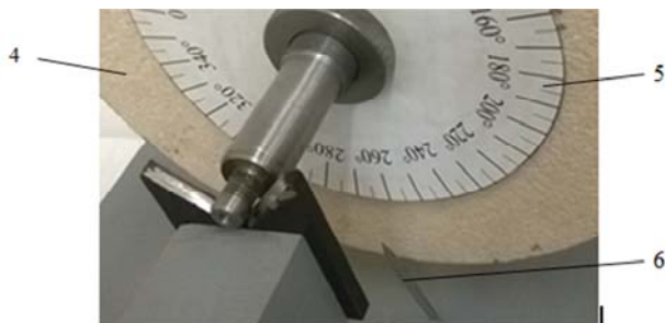
Рис. 4.16. Фотография зоны фиксирования положения шлифовального круга: 4 – испытуемый шлифовальный круг; 5 – градуированная круговая шкала; 6 – указатель
