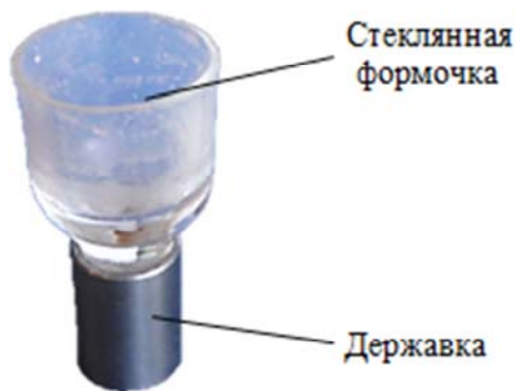
Рис. 8.12. Фотография стальной державки с закрепленной стеклянной формочкой
