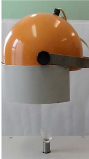
Рис. 8.15. Фотография положения нагревательной лампы относительно стеклянной формочки
