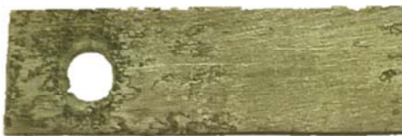
Рис. 6.21. Фотография образца с полученным путем электрохимической обработки отверстием
