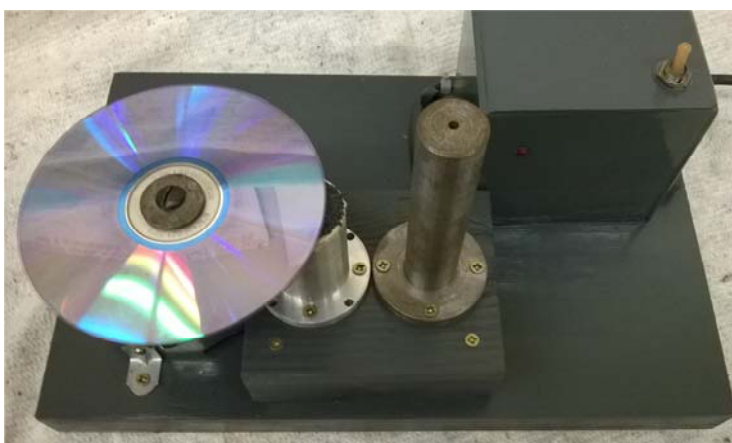
Рис. 12.20. Фотография диска, установленного на валу электродвигателя
