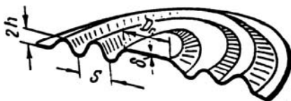
Рис. 9.11. Конструкция мембраны: D_n – диаметр плоского центра; S – шаг гофра; 2h – высота гофра; \delta – толщина мембраны
