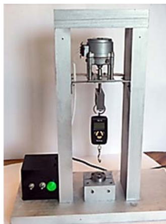
Рис. 13.13. Принципиальная схема (а) и фотография (б) устройства измерения прочности соединения поверхности образца титанового имплантата с имитатором костной ткани:
