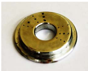
Рис. 11.20. Фотография полированной поверхности образца с полученными на ней лунками
