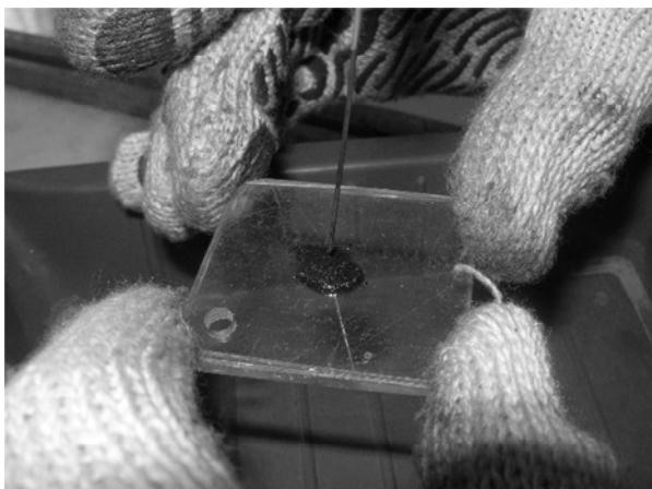
Рис. 3.18. Фотография процесса получения отверстия в стеклянной заготовке
