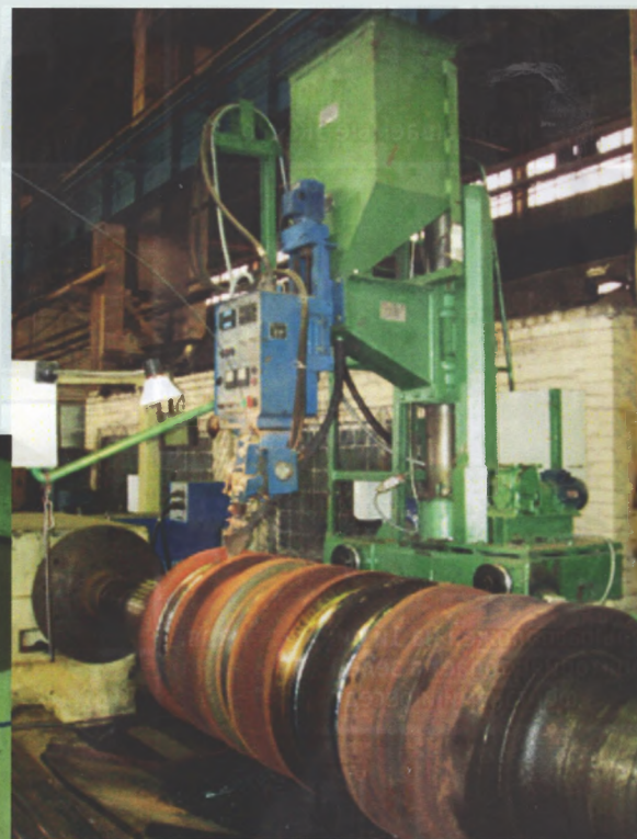
Комплекс наплавочного оборудования РМ-12 для наплавки прокатных валков на базе токарного станка
