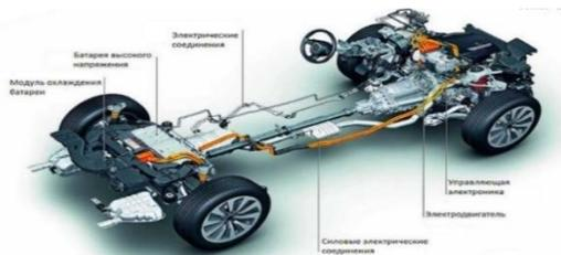
Рисунок 2 – Принципиальная схема гибридного автомобиля [3]
