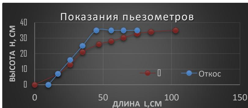
Рисунок 1.— Определение высоты фильтрационного выпора на экспериментальной модели
