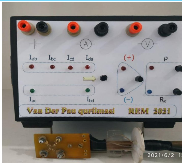
Рис. 2. Внешний вид разработанной установки для измерения подвижности носителей заряд методом Ван дер Пау
