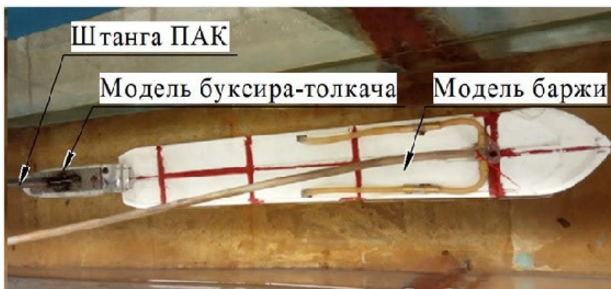
Рисунок 2 – Модель баржи в режиме толкания.
