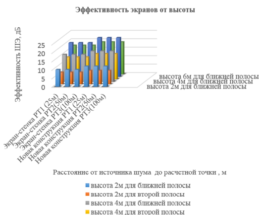
Рисунок 2 – График эффективности конструкций ШЭ в зависимости от высоты
