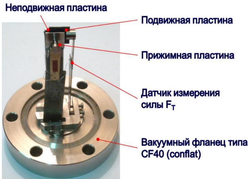
Рис. 1 – Макет измерительного блока датчика измерения чистоты рабочей поверхности изделия в вакууме
