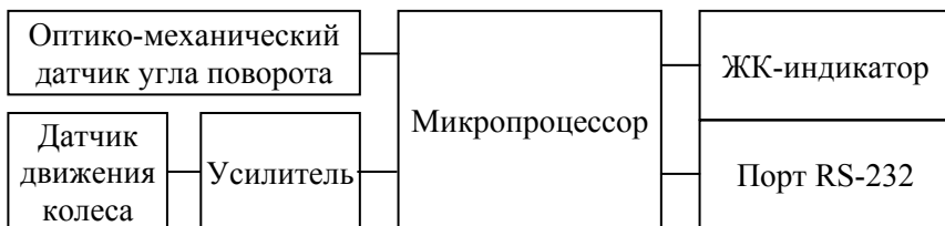
Рис. 1.3. Функциональная схема люфтомера ИСЛ-401
