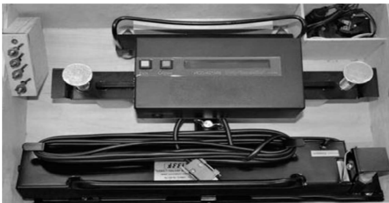
Рис. 1.1. Люфтомер рулевого управления ИСЛ-401
