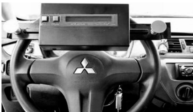
Рис. 1.4. Установка основного блока люфтомера
