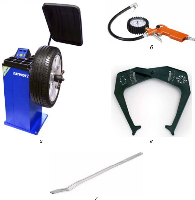
Рис. 3.1. Инструмент для проведения шиномонтажа и балансировки шин: а – станок балансировочный ЛС111 «Патриот 2»; б – устройство для накачки шин с манометром; в – кронциркуль; г – монтажная лопатка
