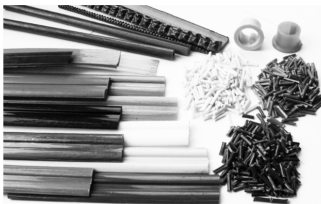
Рисунок - Полуфабрикаты и профильные изделия из отходов термопластичных полимеров
